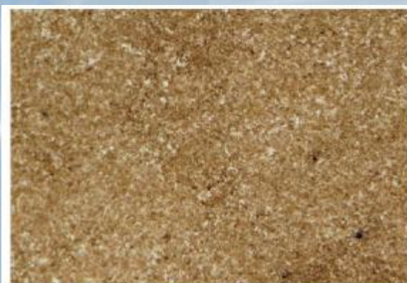
OTV1C-Mikrostruktura martenzita v kaljenem jeklu, karbidi in ostanek zaostalega avstenita
